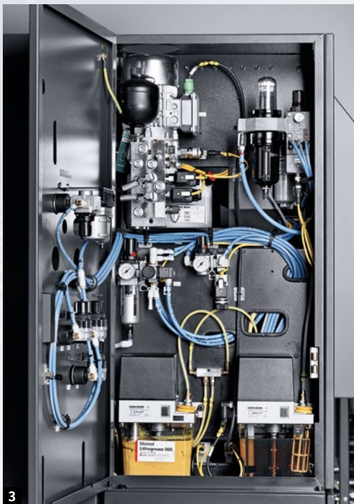
1+2: 冷却的滚珠丝杠螺母和导轨 3: 易于查看和接近的液压系统
