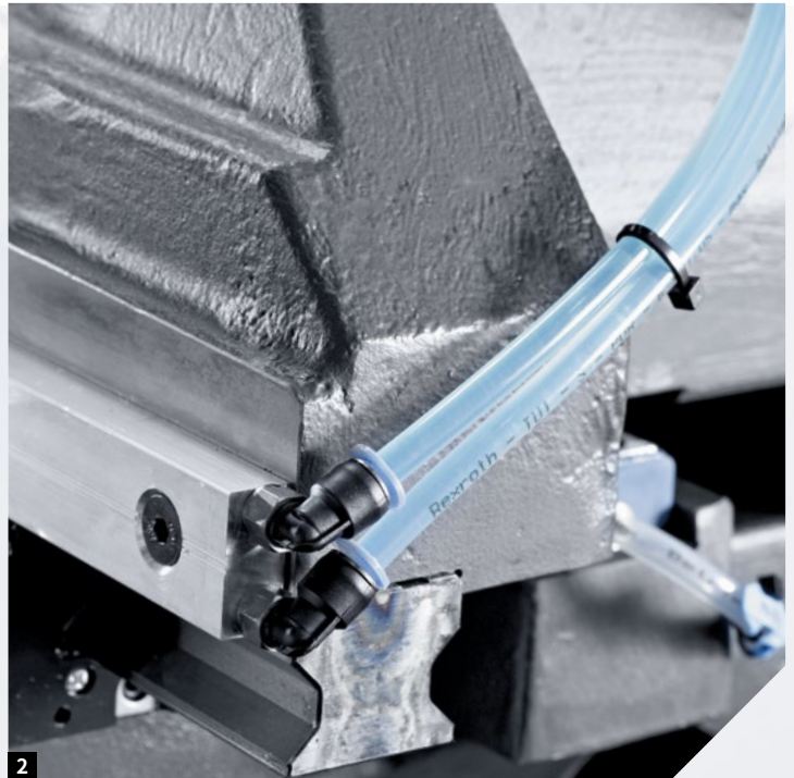
1+2: 冷却的滚珠丝杠螺母和导轨 3: 易于查看和接近的液压系统
